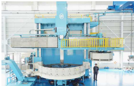
丸善機械がレンタルする中古大型工作機械の一つ、オーエム製作所製の立型旋盤「TMD-40/45」
